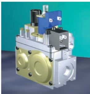
**Control multifuncional de seguridad termoelectrónica, con selector monomando y modulador eléctrico de la presión de gas en salida, para equipar aparatos de gas que requieren regular el caudal del gas en función de la temperatura.**
